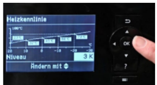
Abbildung 10: Niveau der Heizkennlinie anpassen. Hier mit Heizkennlinie im Display
